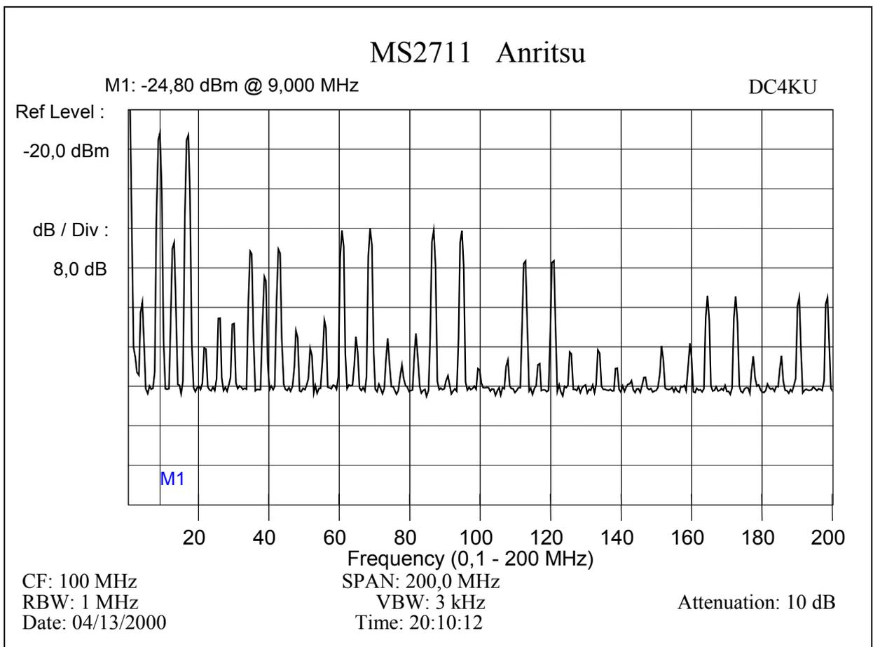
**Bild 5:** Spektrum am Ausgang des Mixers
