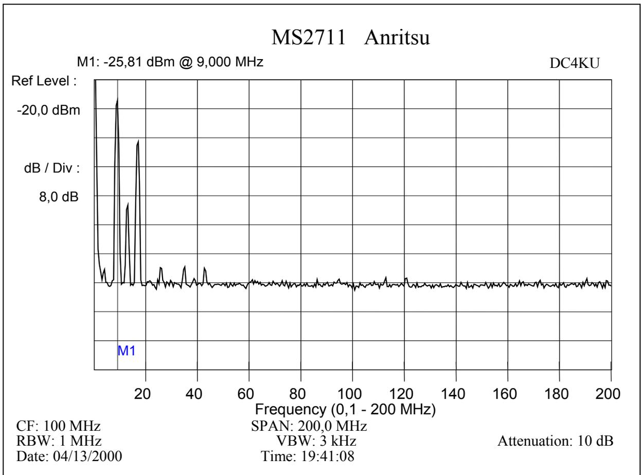
**Bild 7: Spektrum am Ausgang des Diplexers**
