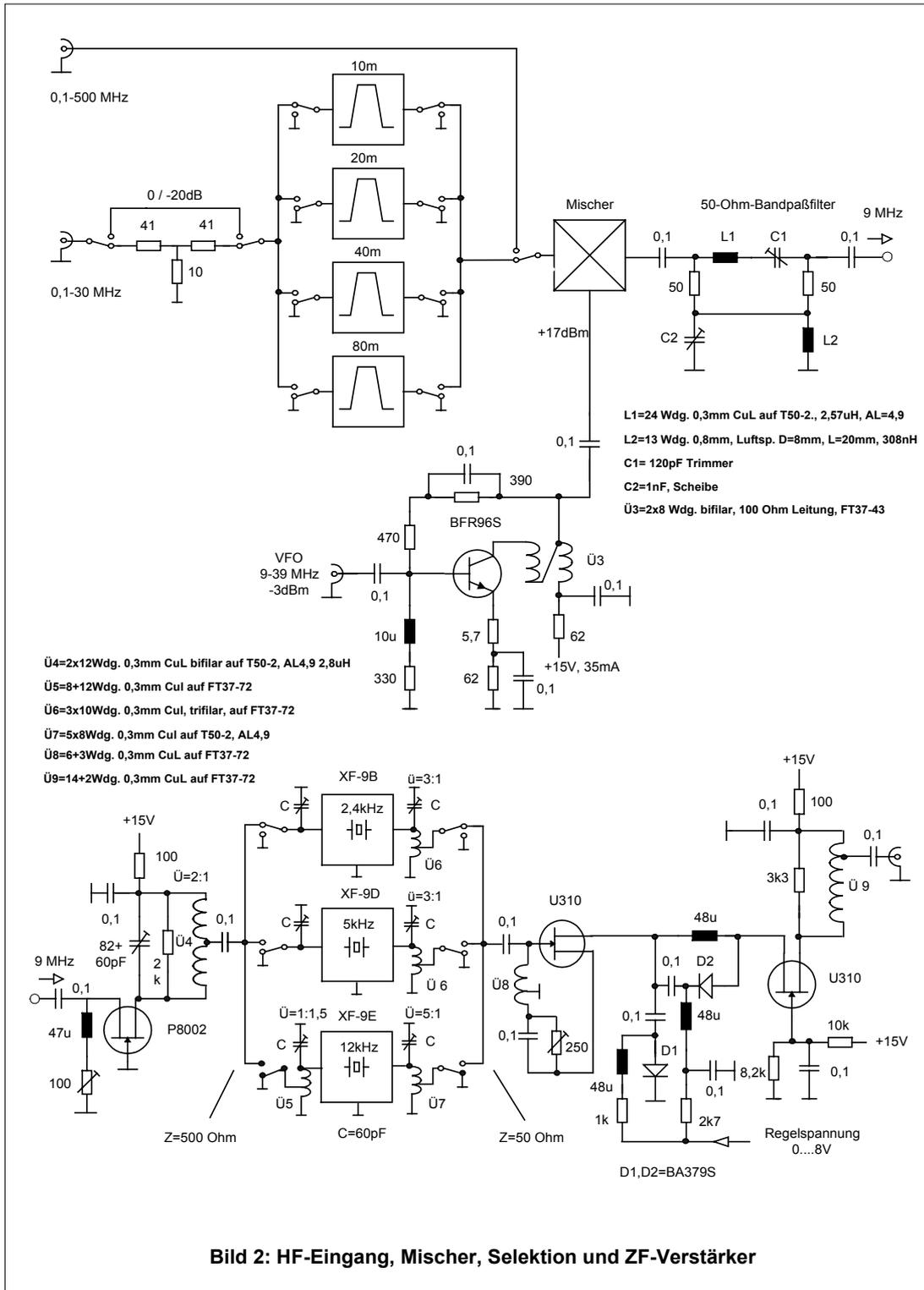
Bild 2: HF-Eingang, Mischer, Selektion und ZF-Verstärker
