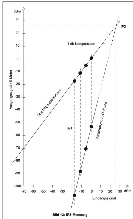
Hinweis: Führt man die IP3-Messung mit Hilfe eines Spektrumanalysators durch, wird dieser am 50-Ohm-Ausgang des Quarzfilters angeschlossen. Die Nutzsignale ( $P_e$ ) bringt man auf Referenzpegel (oberste Horizontallinie des Displays) und liest die IM3-Störprodukte nach entsprechender Abstimmung des VFO's direkt als Pegeldifferenz  $\Delta IM3$  ab (6). Auch hier gilt die Gleichung
