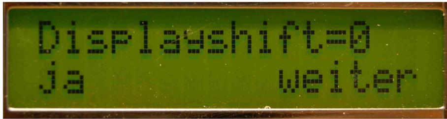
Mit der Taste „ok“ oder „ja“ wird der Shiftwert auf 0 gesetzt und wir sehen die eigentliche Empfangsfrequenz. Deshalb muss zuerst im normalen Betrieb die genaue Empfangsfrequenz eingestellt werden (ZF-Ausgang des Transverters) und anschliessend den anzuzeigenden Frequenzwert der Transverterempfangsfrequenz.
