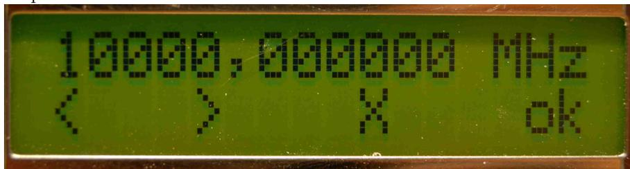
Hier stellen wir die Transverterempfangsfrequenz ein. In diesem Fall sind das 10GHz. Besser einstellen kann man diese Werte im PC-Programm. Dort sieht man auch sofort die Transverter-ZF-Frequenz und braucht nicht erst so viele Schritte durchführen.
