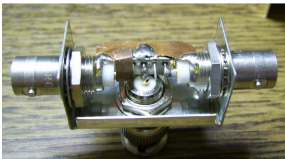
Abb. 1: Zusätzliche Masseverbindung am Exemplar OE5GPL.
