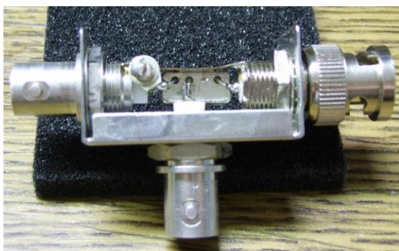
Abb. 5: Aufbau des TDC-10 Richtkopplers nach OE5EBL
