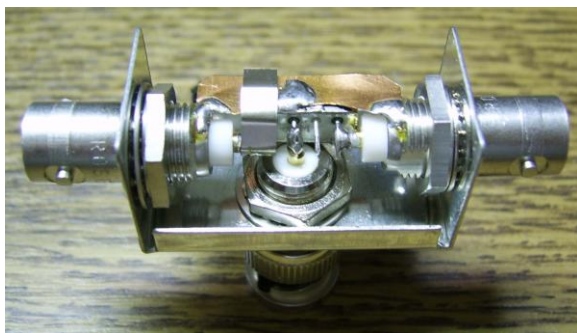
Abb. 3: Zusätzliche Abgleichfahne am Exemplar OE5GPL
