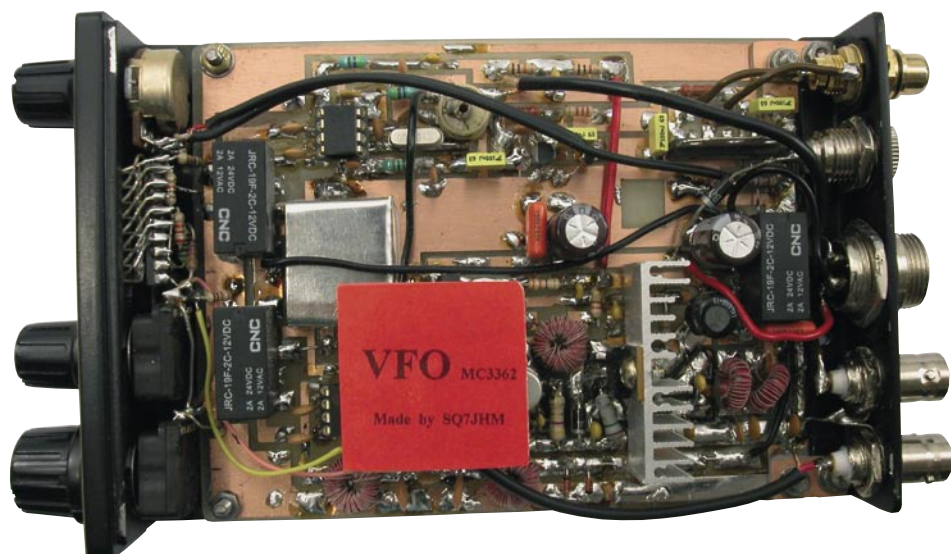
Rys. 3. Fragment wnętrza transceivera
