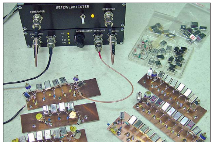
Bild 21: Ansicht einiger der zahlreichen praktischen Versuchsaufbauten zur Messung am FA-NWT; durch die fehlende Schirmung und Massekontaktierung der Quarze ist die Weitabselektion der Versuchsaufbauten begrenzt.
