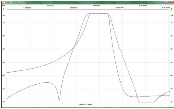
Bild 6: Durchlasskurve eines nach bislang bekannten Methoden aufgebauten vierpoligen Abzweigfilters für etwa 4,0 kHz Bandbreite im Vergleich zur symmetrischen Filterlösung (geringfügig größere Bandbreite); bei Kompensation der Gehäusekapazitäten verbessert sich die Steilheit der unteren Filterflanke durch Polbildung.
