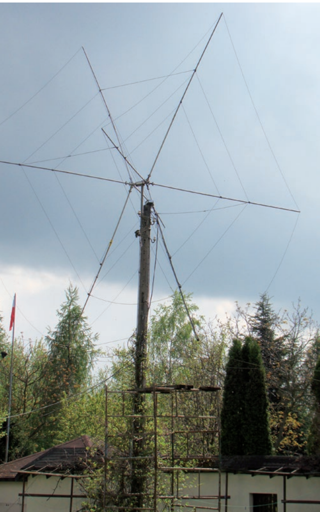
Antena QQ konstrukcji SP3GEM u Andrzeja SP5SA
