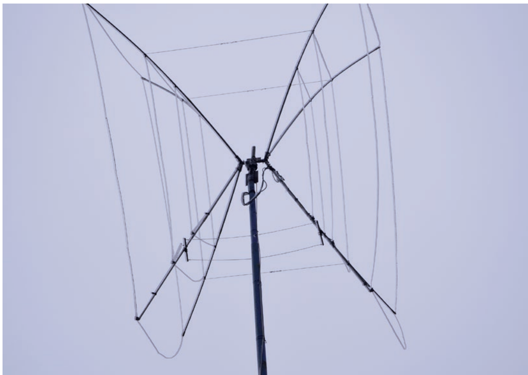
Antena QQ konstrukcji SP3GEM w czasie ostatniego oblodzenia (pierwszy model wykonany w celach testowych, który służy do dnia dzisiejszego)
