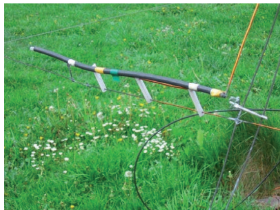
Jeden z elementów dopasowania Gamma zasilania ramki wibratora
