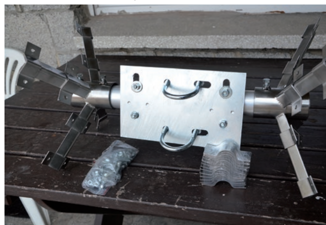
Krzyżak montażowy QQ wg SP3GEM
